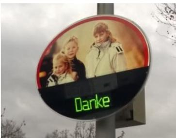
Auf diesem Displaysystem wurde den Fahrzeugführern durch die Begriffe „Langsam“ bei überhöhter sowie „Danke“ bei ordnungsgemäßer Geschwindigkeit unmittelbar Rückmeldung zu ihrem Fahrverhalten gegeben.
